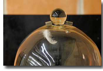
FIGURE 3.7 Dans le vide, en absence de frottement, la plume et le cube de plomb ont la même accélération.
